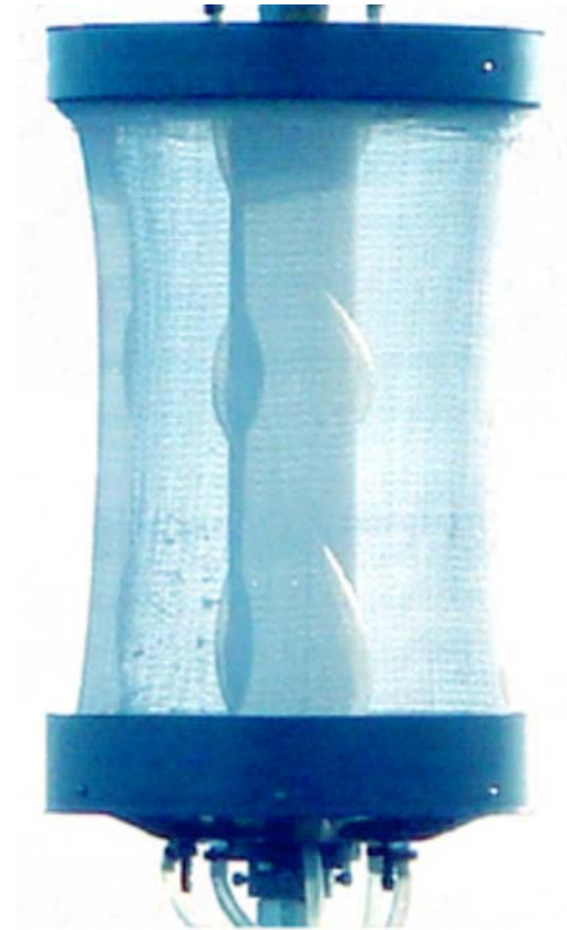
Figura 4. Col·lector de boira cilíndric a base de malla tipus Raschel
