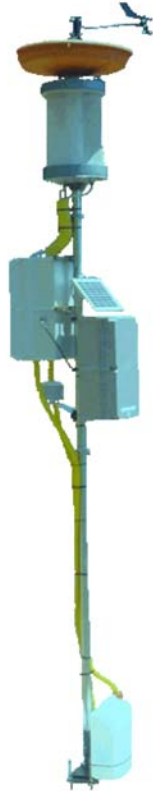
Figura 5. Sistema integrat per a la prospecció de la recollecció de l'aigua de boira. Inclou una garrafa per al mostreig químic de l'aigua de boira a la part inferior
