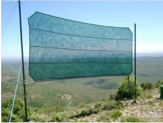
Figura 9. Col·lector pla de 18 m 2 de malla recollidora instal·lat a Aiora (València). L'aigua capturada fou utilitzada per a la restauració forestal de la zona
