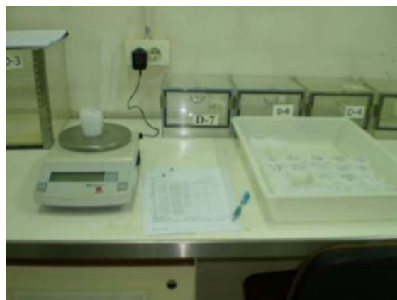
Imatge 5. Pesatge dels reactors de tefló
