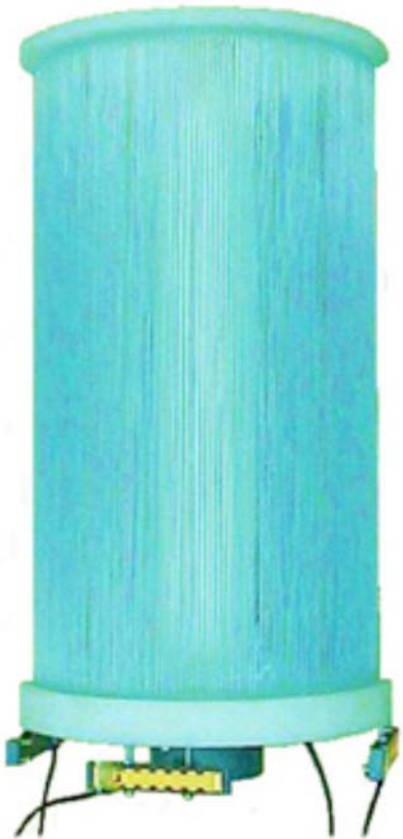
Figura 3. Col·lector de boira cilíndric a base de fils de niló
